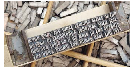
Winkelhaken, Setzkasten und Bleiletern: Werkzeuge des Schriftsetzers.
