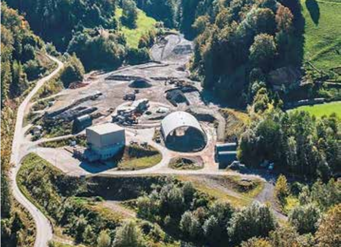
Übersicht über Anlieferung, Umladestation für Kehrrecht (graues Gebäude rechts im Hintergrund) und Entschrottungsanlage mit Schlacketrocknungshalle (mitte).
